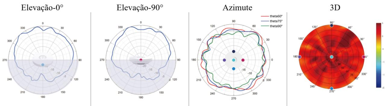
Figura 13.6: Diagrama de radiação para 5 GHz banda média
