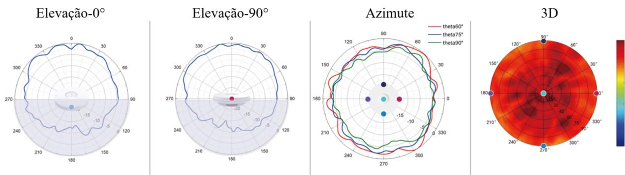
Figura 13.7: Diagrama de radiação para 5 GHz banda alta
