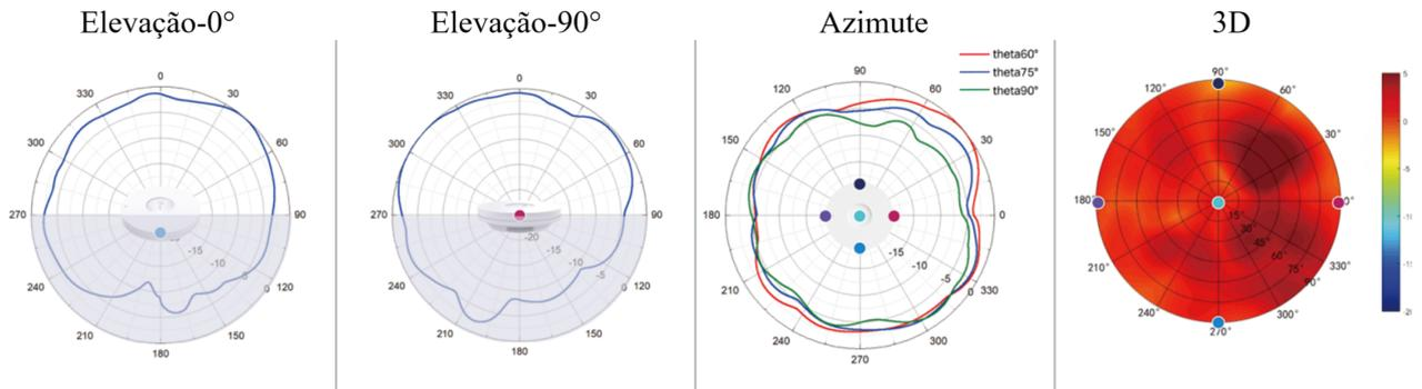
Figura 13.4: Diagrama de radiação para 2,4 GHz
