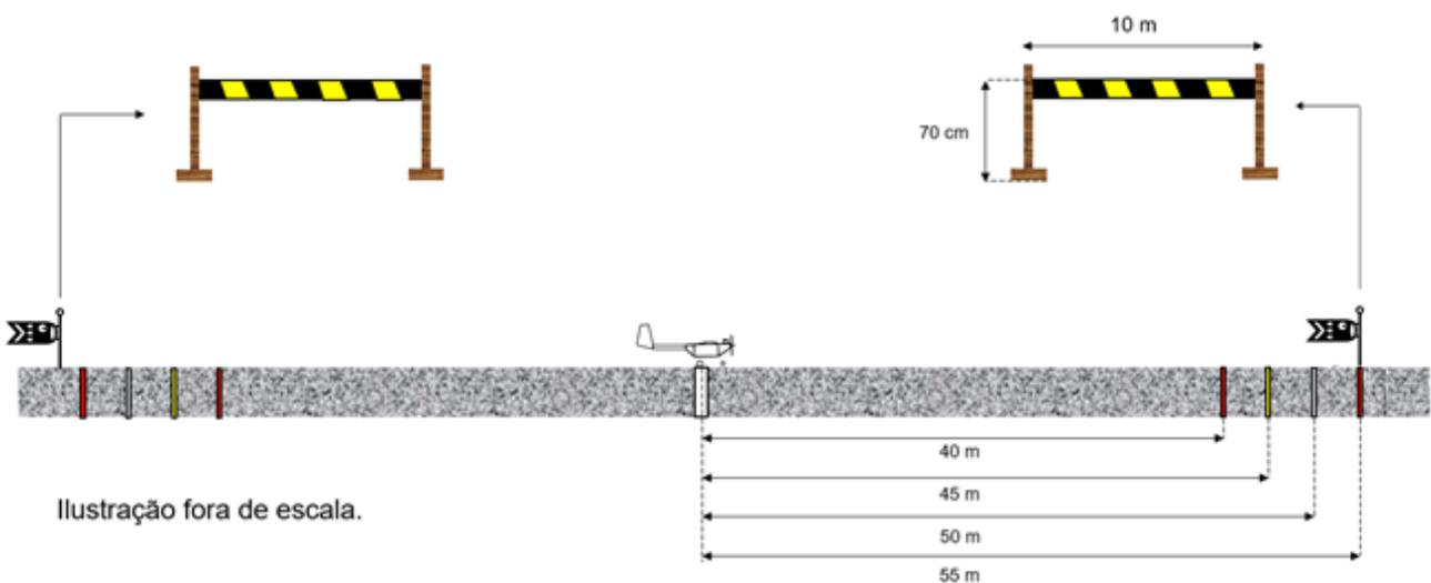
Figura 8.4: Decolagem válida Classe *Advanced*: pista com obstáculo.
