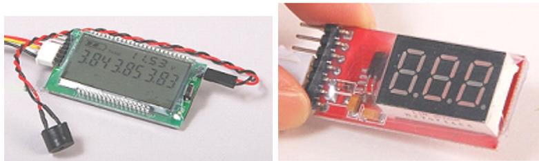
Figura 6.5: Exemplos de VoltWatch para baterias LiFePO<sub>4</sub>.
