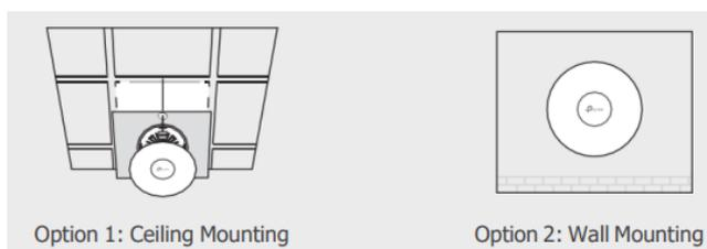
Figura 13.8: Opções de instalação para o transceptor
